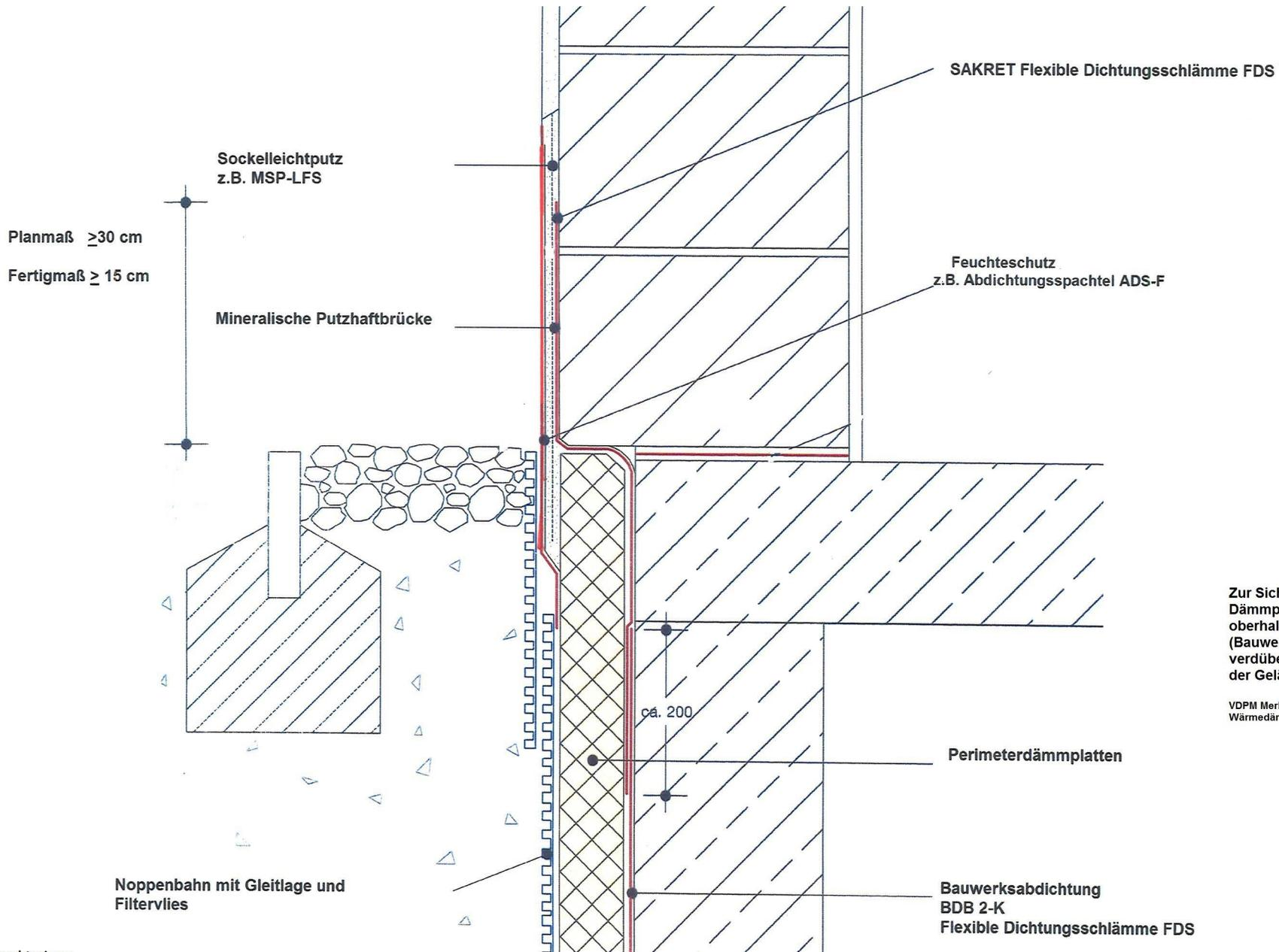
Zur Sicherheit gegen Abrutschen der Dämmplatten oberhalb der Abdichtungsebene (Bauwerksabdichtung nach DIN 18533-1 [2]) zu verdübeln, in der Regel mindestens 15 cm über der Gelände- bzw. Belagsoberkante.
