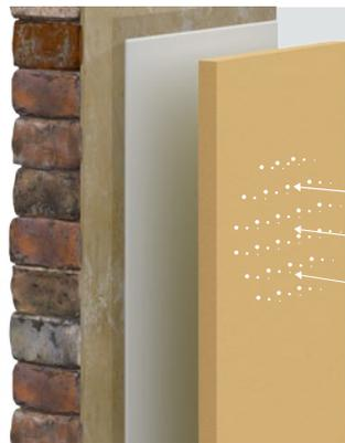
Bedingt durch das Temperaturgefälle zur kalten Innenwand bildet sich innerhalb der Dämmplatte Tauwasser. Meist liegt der Taupunkt im Bereich des Klebemörtels. Die poröse Innendämmplatte speichert das Wasser.
