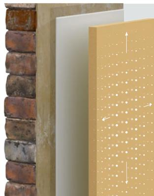
Die kapillar aktive Dämmplatte leitet die anfallende Feuchte zurück in Oberflächennähe und damit aus dem Taupunkt heraus in die Verdunstungszone. So wird der Feuchtegehalt der Raumluft ausgeglichen.
