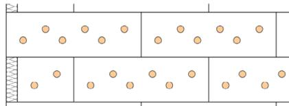
**Dübelbilder bei Dübelung auf Fläche/Fuge**
