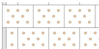
**Dübelbilder bei Dübelung auf Fläche/Fuge**
